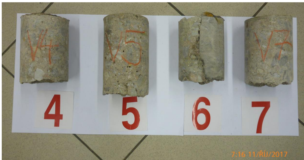
Foto č.1: Dokumentace vývrtů pro destruktivní zkoušky pevnosti v tlaku betonu
